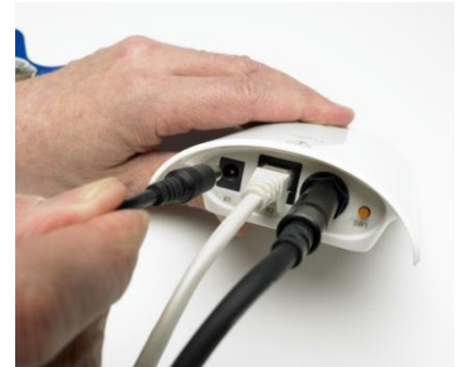
Koppla in nätadaptern i X1-märkta anslutningskontakten.
