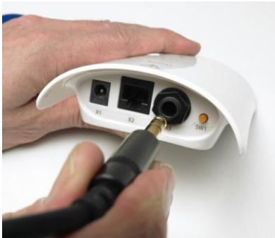
Koppla i sensorkabeln till kontrollenhetens anslutningskontakt märkt X3.
